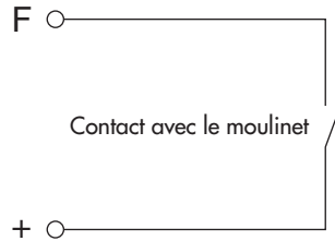
Fig. 6 : Schémas de connexion possibles de treuils mécaniques/électriques et de moulinets sur saumon associés au compteur OTT Z400. Le schéma sur fond gris correspond à l'application standard lors de l'utilisation de treuils électriques OTT. Dans les deux cas de « moulinet sur saumon sans contact avec le fond », vous devez arrêter une mesure par intégration manuellement. Si l'on n'utilise pas de résistance de 680 ohms (applications illustrées à droite), la fonction de contact avec le fond doit être réglée de manière fixe sur « sans contact avec le fond » (= 0) ou sur « détection automatique du contact avec le fond » (= 2).
