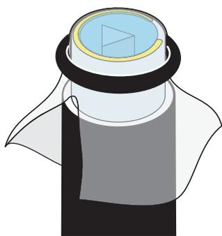
5. Fixez la membrane avec le joint torique. Assurez-vous qu'il n'y a pas de plis dans la membrane ni de bulles dans l'électrolyte.
