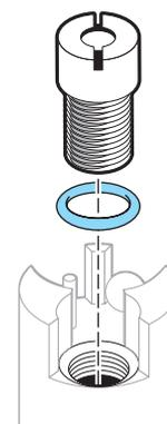
4. Remplacez le joint torique placé en-dessous du raccord de référence en Teflon s'il est détérioré ou desserré.
