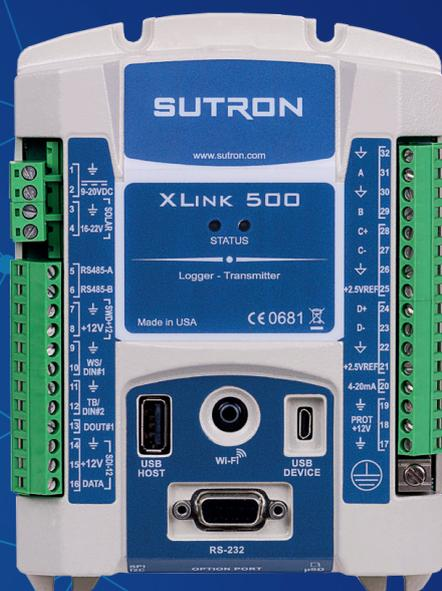
*Réglage simple et intuitif de l'enregistreur de données et des communications en Wi-Fi à l'aide d'un smartphone, d'une tablette ou d'un PC.*
