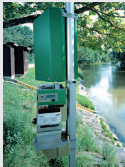
Exemple d'intégration d'un Logosens dans la CompactStation OTT
