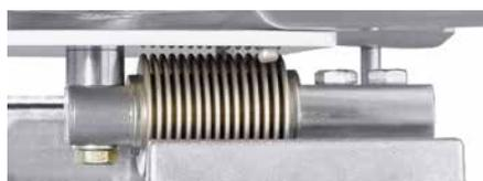
l'intensité des précipitations compensées en température. Un capteur de température intégré fournit alors la température ambiante actuelle. OTT Pluvio<sup>2</sup> L soumet les données brutes ainsi obtenues à un contrôle de vraisemblance. Les facteurs d'influence gênants comme le vent ou la température par ex. sont éliminés au moyen d'un algorithme mathématique : des données de précipitations corrigées sont ainsi disponibles.
