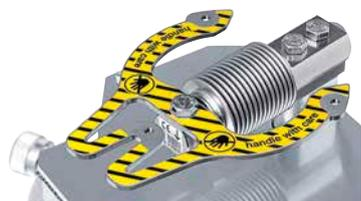
Comme tous les appareils de la série OTT Pluvio, OTT Pluvio<sup>2</sup> S utilise une méthode de mesure fonctionnant selon le principe de pesée. Une cellule de pesée de haute précision en acier inox, scellée hermétiquement et étalonnée pour
