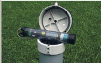
Le codeur angulaire à flotteur OTT Thalimedes a été conçu pour mesurer en continu le niveau des eaux souterraines et de surface. C'est un moyen peu onéreux d'obtenir des mesures fiables dans des puits à flotteur ou des tubes de forage à partir de 4". Il peut facilement être associé à des limnigraphes pour fournir des données numériques à peu de frais.
