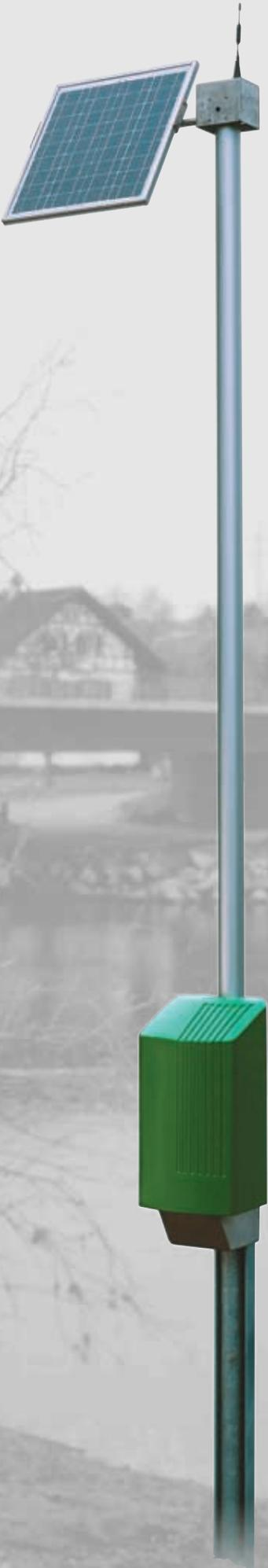
Station de mesure autonome pour l'acquisition de données hydro-météorologiques
