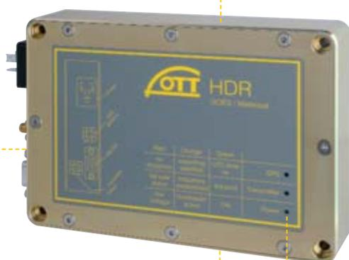
Synchronisation automatique de l'heure et de la fréquence par GPS
