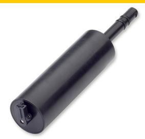
Les sondes Hydrolab utilisent un capteur de turbidité auto-nettoyant qui mesure de 0 à 3 000 NTU et inclut un système de nettoyage programmable par l'utilisateur pour supprimer l'encrassement ou les débris susceptibles de nuire aux relevés.
