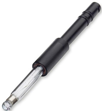
Le capteur ORP développé par Hydrolab utilise un anneau de platine qui libère ou absorbe des électrons afin d'observer les réactions chimiques, de déterminer l'activité ionique ou les propriétés oxydo-réductrices d'une solution.
