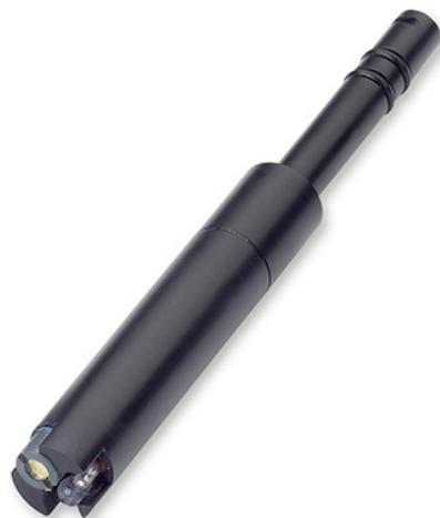
Le capteur de pH Hydrolab utilise une électrode de mesure sous forme de bulle de verre et une électrode de référence remplissable.
