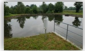
**Baustein „Alarmpegel“:** Wasserstandsüberwachung für Bäche / Flüsse
