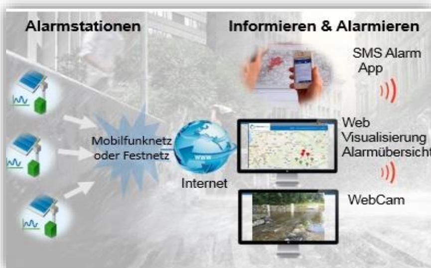
Für den Aufbau einer **zuverlässigen Warn- und Informationsinfrastruktur** greifen wir auf ein flexibles Systemkonzept zurück. Die verschiedenen Systemkomponenten können optimal an die Vorgaben und Bedürfnisse wie z.B. Topografie, Informationsbedarf, Telekommunikationsinfrastruktur angepasst und erweitert werden.
