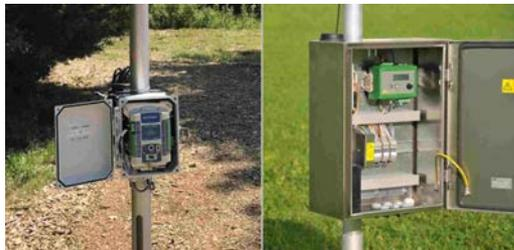
Connexion à l'enregistreur de programme pour collecter les mesures à la fréquence voulue et déclencher le balai
