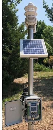
An einen Datalogger anschließen: über SDI-12\* oder Modbus\*\*.
