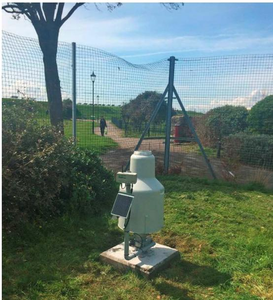
Das Messnetz besteht aus zehn Sensoren zur Füllstandsmessung, vier Pumpenüberwachungssystemen und vier Niederschlagsmessern vom Typ OTT Pluvio<sup>2</sup>. Sie alle senden ihre Daten in Echtzeit über ein Adcon-Funksystem an ein computergestütztes Modell des gesamten Wassereinzugsgebiets.
