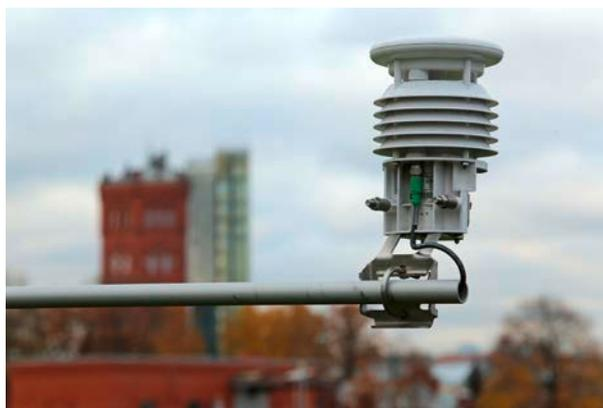
Das Monitoring-System „CIS Precipitation“ sammelt die Wetterdaten automatisch und sendet sie zur Auswertung im Fünf-Minuten-Takt, rund um die Uhr an das System von Roshydromet sowie an die Zentrale des Abwasserentsorgers SU-E Vodokanal.
