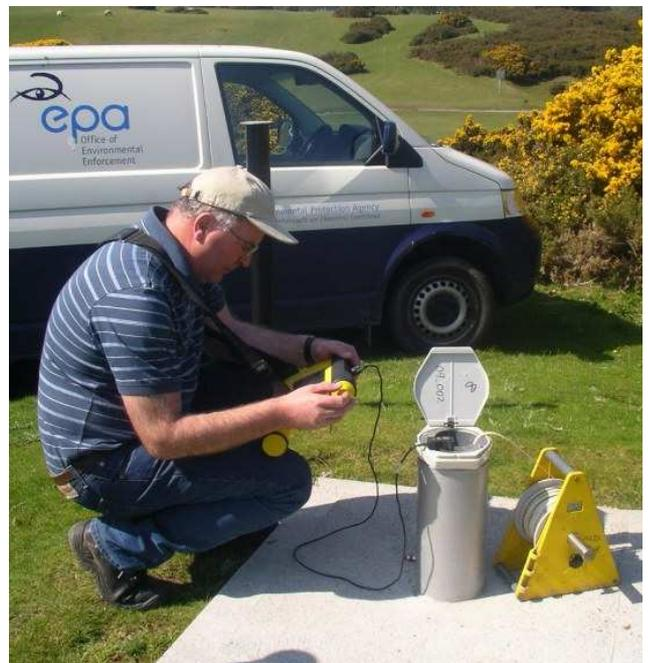
*WFD Grundwassermessstelle: im Rohr installiert ist ein OTT Orpheus Mini. Referenzmessungen mit OTT KL 010 Kabellichtlot.
