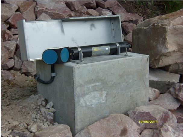
Montierter Sensor der oberen Messebene mit abschließbarer Schutzhaube
