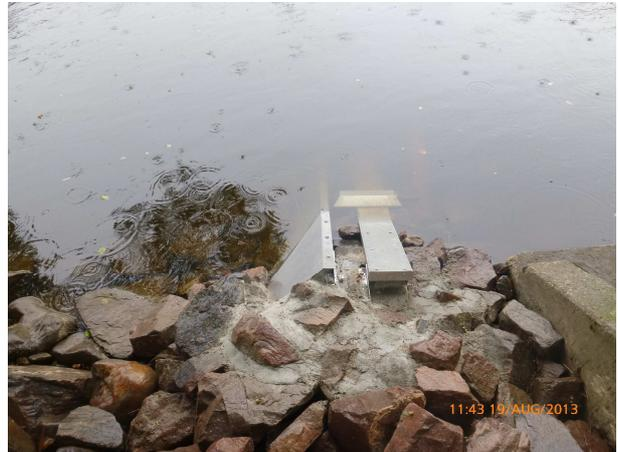
*Umgebauter Geräteträger der unteren Messebene mit Abweiserblech*
