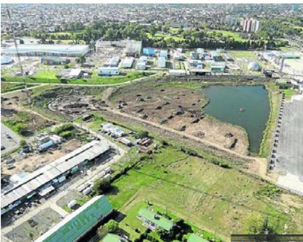
Um weitere Überschwemmungen zu verhindern ließ die Regierung ein Rückhaltebecken mit einem Fassungsvermögen von 300.000 m<sup>3</sup> bauen, mit dessen Hilfe während starker Regenfälle der Abfluss im Mendrano geregelt werden soll.
