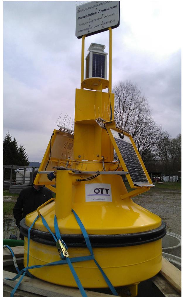
Die Temperatursensoren der Messkette und die Kompaktwetterstation zeichnen kontinuierlich Daten auf (15 Minuten-Mittelwerte). Die Messdaten werden im OTT **netDL** Datensammler im Inneren der Boje gespeichert. Mehrmals am Tag werden die Daten über Mobilfunk von der Messstation an eine Datenbank der Wasserwirtschaftsverwaltung übermittelt, wo sie direkt für Auswertungen zur Verfügung stehen.
