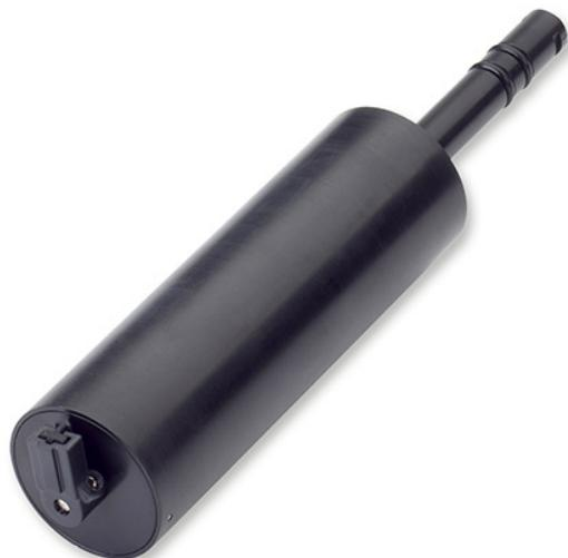
Las sondas Hydrolab utilizan un sensor de turbidez que mide de 0 a 3000 NTU e incluye un sistema de limpieza programable por el usuario y autom para eliminar la suciedad y los residuos que podrían afectar a la lectura.
