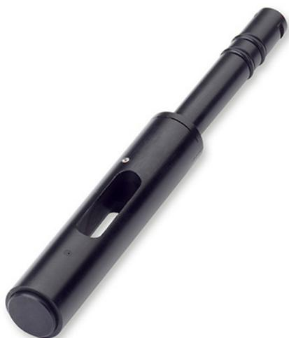
El sensor de conductividad Hydrolab utiliza cuatro electrodos de grafito en una célula abierta para proporcionar datos extremadamente precisos y fiables con un mantenimiento muy reducido. Se utiliza para medir la conductividad específica, la salinidad, el total de sólidos disueltos (TDS) y la resistividad.
