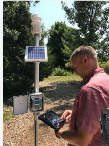
Configuración rápida del sensor meteorológico todo en uno Lufft
