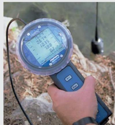
Indicación simultánea de hasta 5 valores de medición.
