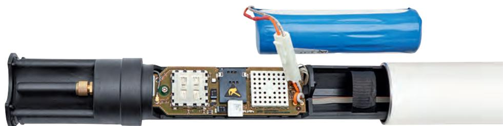
ACCESO RÁPIDO PARA INSERTAR LA TARJETA SIM O CAMBIAR LA BATERÍA
