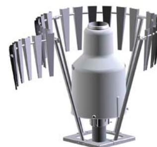
*Segmento móvil para acceder con seguridad al medidor de precipitación*
