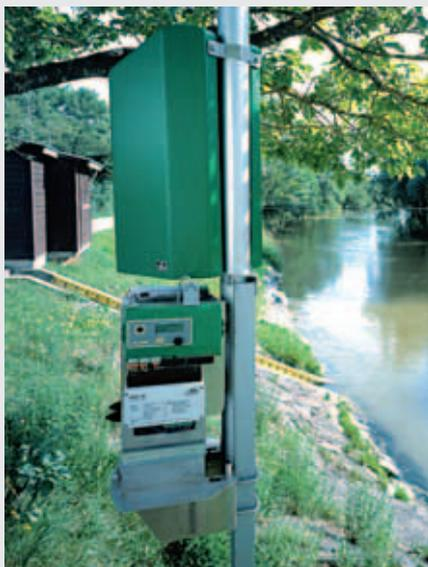
Controlador de estación LogoSens en una estación CompactStation como alternativa a una caseta o como estación redundante para un alto potencial de disposición de datos-también en caso de desastres.
