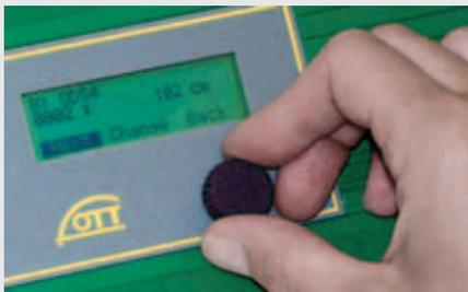
La indicación de los valores del sistema y de medición son visibles por medio de un „display“ con capacidad gráfica el cuál está integrado en el LogoSens. Para la lectura de datos manual y parametrización en sitio por medio de un ordenador portátil (Notebook) se realiza utilizando el puerto infrarojo (IrDA) ó el puerto RS 232 integrado en el LogoSens.
