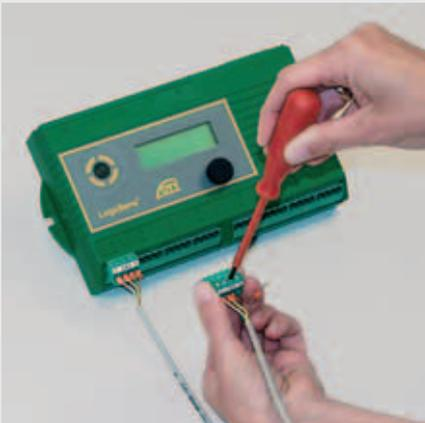
Los conectores con fijación del cable por medio de tornillos permiten una conexión sencilla de los sensores así como de la alimentación eléctrica sin tener que abrir el equipo.
