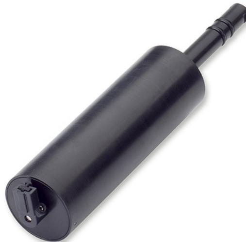
Hydrolab Sonden sind mit einem selbstreinigenden Trübungssensor ausgestattet, der einen Messbereich von 0 bis 3000 NTU abdeckt. Er verfügt über ein programmierbares Reinigungssystem, um Biofilm oder andere Ablagerungen zu beseitigen, die das Messergebnis verfälschen könnten.
