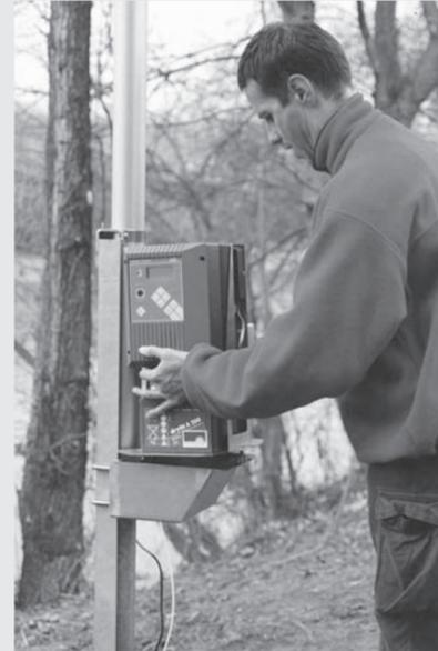
Baugruppenträger aufsetzen; Sensoren anschließen; Schutzgehäuse schließen.
