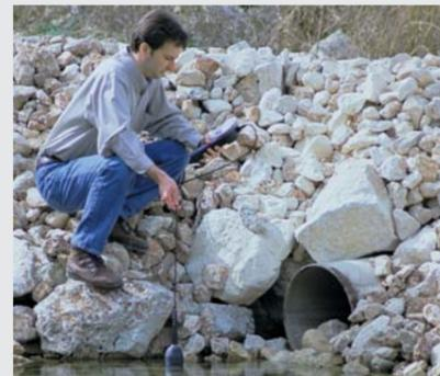
**Portable Online-Messung der Wasserqualität an einem Abwasserzulauf**
