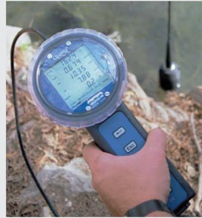
**Mobile Momentanwerterfassung mit Speicheroption: Gleichzeitige Anzeige von bis zu 5 Parametern**
