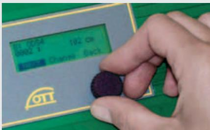
Die Anzeige der System- und Messwerte erfolgt über ein grafikfähiges Display welches im LogoSens integriert ist.
