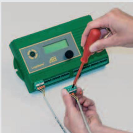
Die steckbaren Schraub-Klemmleisten erlauben einen einfachen Anschluss der Sensoren sowie der Spannungsversorgung ohne das Gerät öffnen zu müssen.
