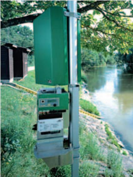
Stationsmanager LogoSens in einer OTT CompactStation als Alternative zu einem konventionellen Pegelhaus oder als redundante Messstelle für eine hohe Datenverfügbarkeit – auch im Katastrophenfall.
