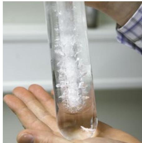
Für höchste Temperaturgenauigkeit im Milli-Kelvinbereich wird der Wassertripelpunkt (Gleichgewichtszustand von allen 3 Aggregatzuständen fest, flüssig und gasförmig) zur Darstellung der internationalen Temperaturskala eingesetzt.
