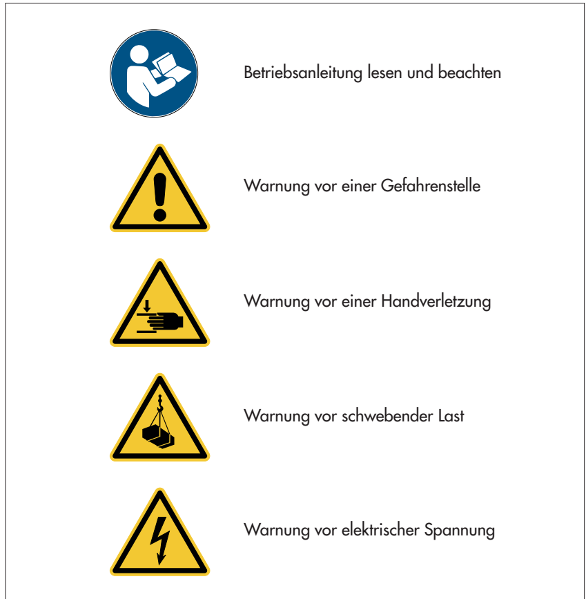
Abb. 8: Erläuterung der Gebots- und Warnzeichen, die an einer OTT Seilkrananlage angebracht sind.
