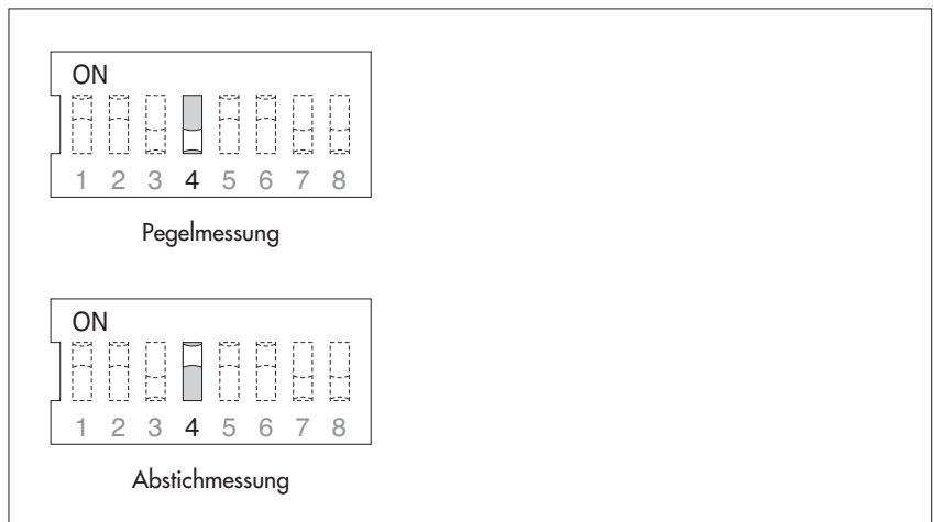
Abb. 12: Messart Pegel- oder Abstichmessung des OTT CBS einstellen (4 ... 20 mA Schnittstelle).
