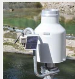
RTU mit Solarpanels am Mastfuß des Niederschlagsensors
