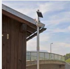
Sensoreinbau im Pegelhaus oder im Pegelrohr am Gewässer RTU mit Solarpanel am Mast
