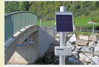
Sensoreinbau im Pegelschacht oder im Schutzrohr am Gewässer
