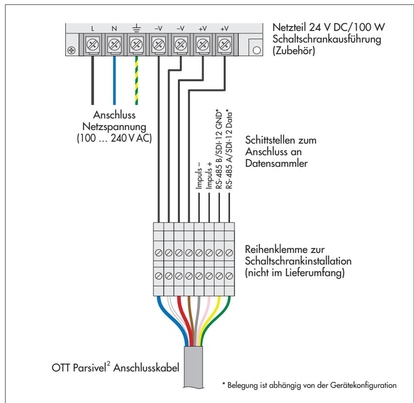
Abb. 16: Netzteil Schutzgehäuseausführung an den OTT Parsivel<sup>2</sup> anschließen.
