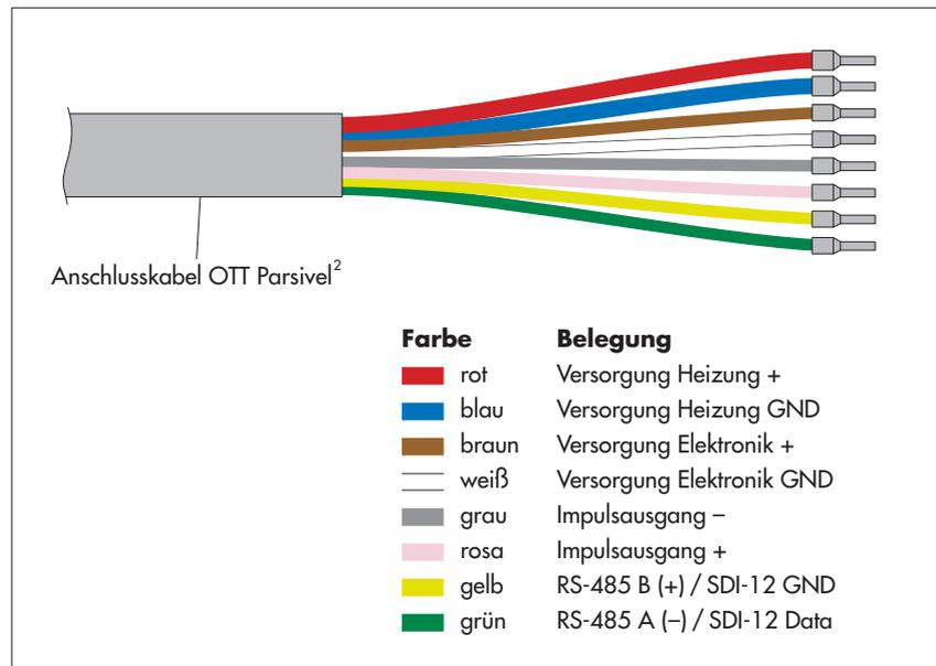
Die gelbe und grüne Ader ist wahlweise mit der RS-485- oder SDI-12-Schnittstelle belegt. Die Auswahl erfolgt bei der Inbetriebnahme über die OTT Parsivel Anwendersoftware ASDO oder über ein Terminal-Programm. Werkseitig sind diese beiden Adern mit der RS-485-Schnittstelle belegt.
