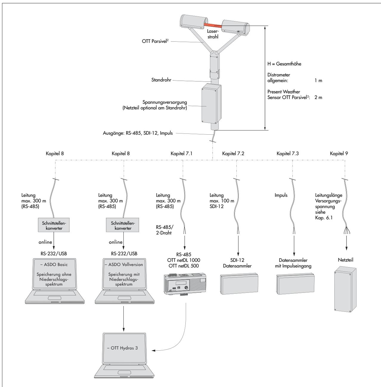
Abb. 2: Anschlussmöglichkeiten an den OTT Parsivel<sup>2</sup>.
