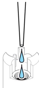
7. Füllen Sie die Referenzöffnung mit Elektrolyt.
