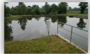
**Baustein Alarmpegel:** Wasserstandsüberwachung für Bäche / Flüsse
